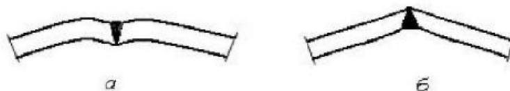
Рис. 1.12. Деформации в листовых конструкциях:
