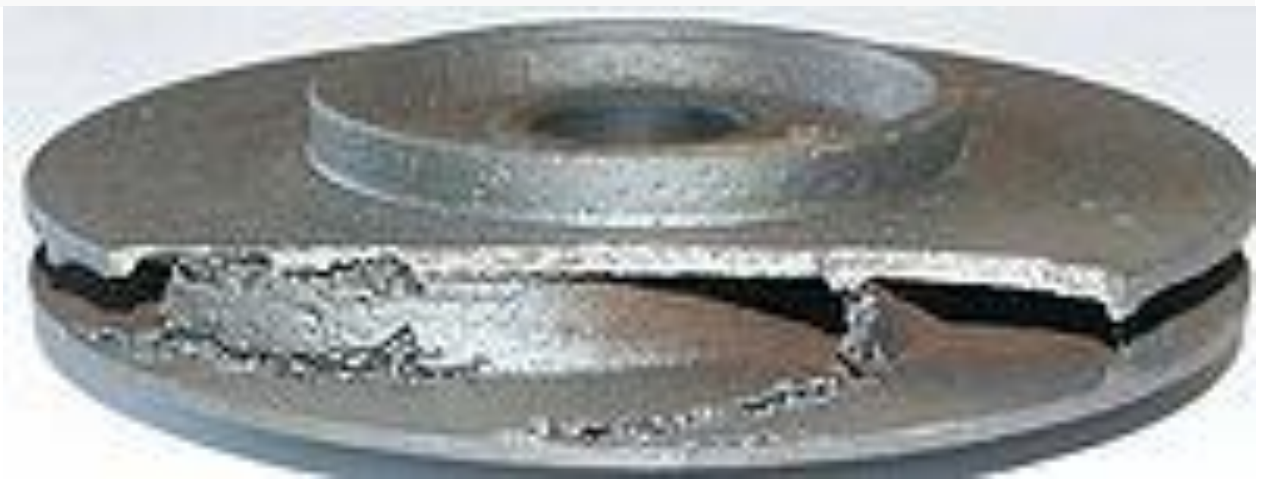
Рисунок 1.2 – Повреждения, наносимые эффектом кавитации (часть насоса)
