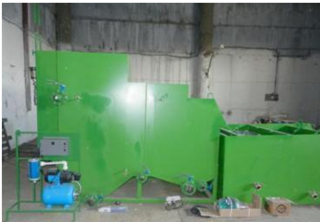
Рисунок 2.7 – Промышленные установки с производительностью очистки сточных 200 \text{ м}^3/\text{час} . для водоканалов и др.
