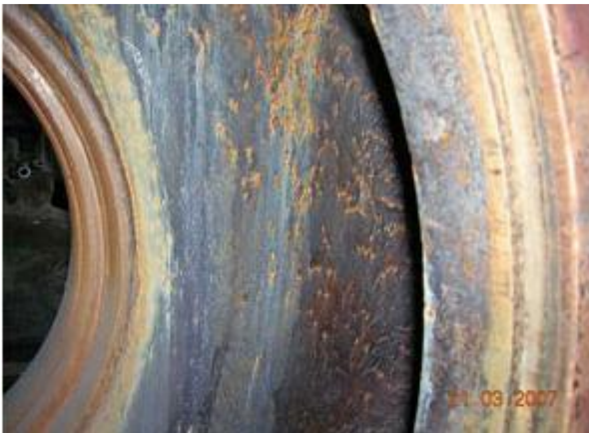
Рисунок 1.7 – Кавитация улитки после года работы насоса.
