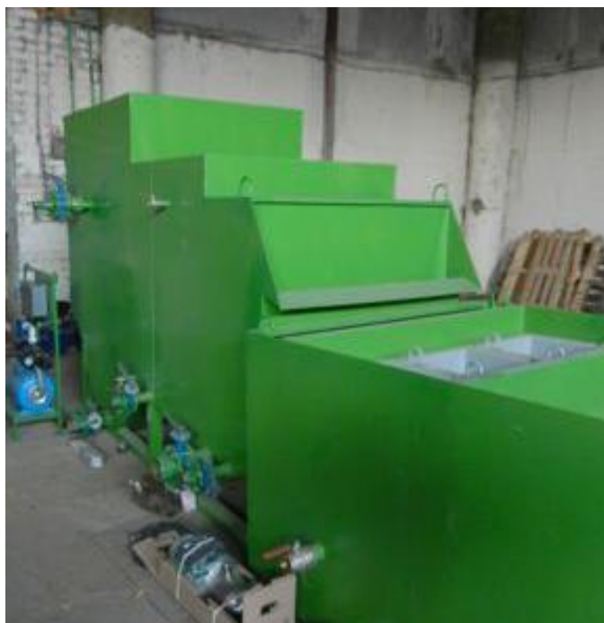
Рисунок 2.6 – Промышленная установка для очистки воды
