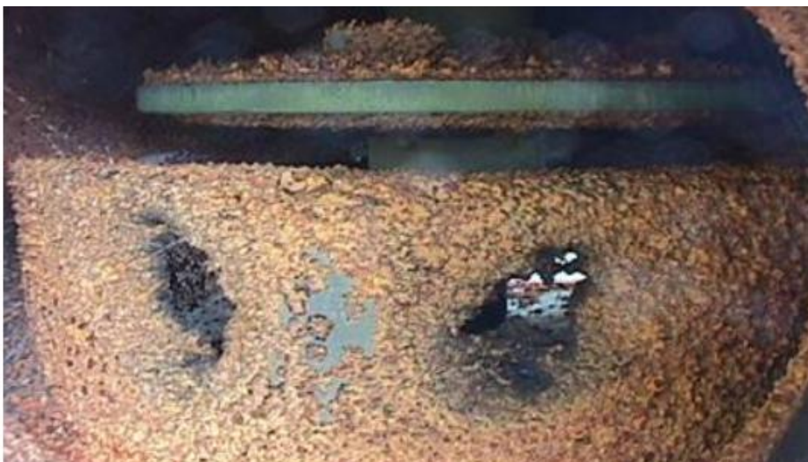
Рисунок 1.9 – Последствия кавитации корпуса трёхходового клапана.
