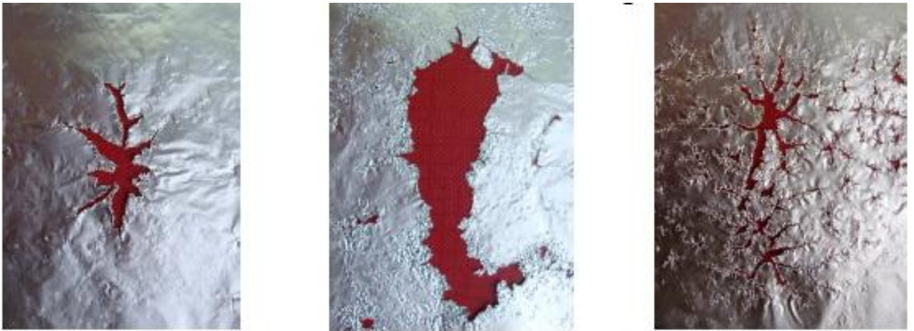
Рисунок 3.5 – Результаты разрушения тестовых образцов фольги в кавитаторе при различных уровнях звукового давления.
