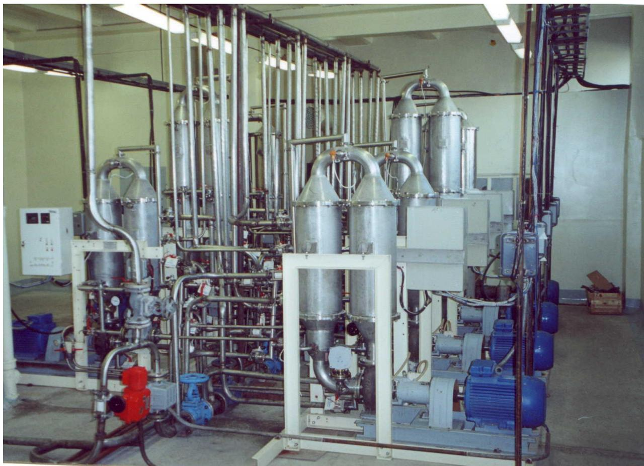
Рисунок 2 - Микрофльтрационная установка
