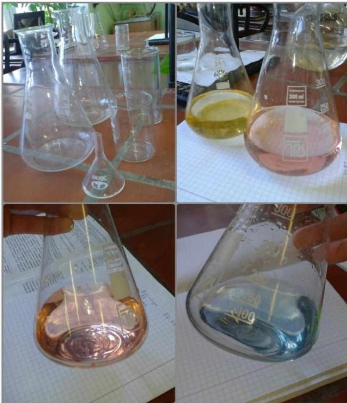
Рисунок28– Анализ общей жесткости воды взятой на ОАО «ТКЗ» проводимый в Лаборатории Института экологии Волжского бассейна РАН
