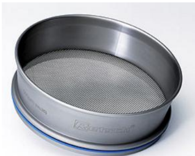
Рисунок 3.6 Образец лабораторного сита, для определения фракционного состава песка
