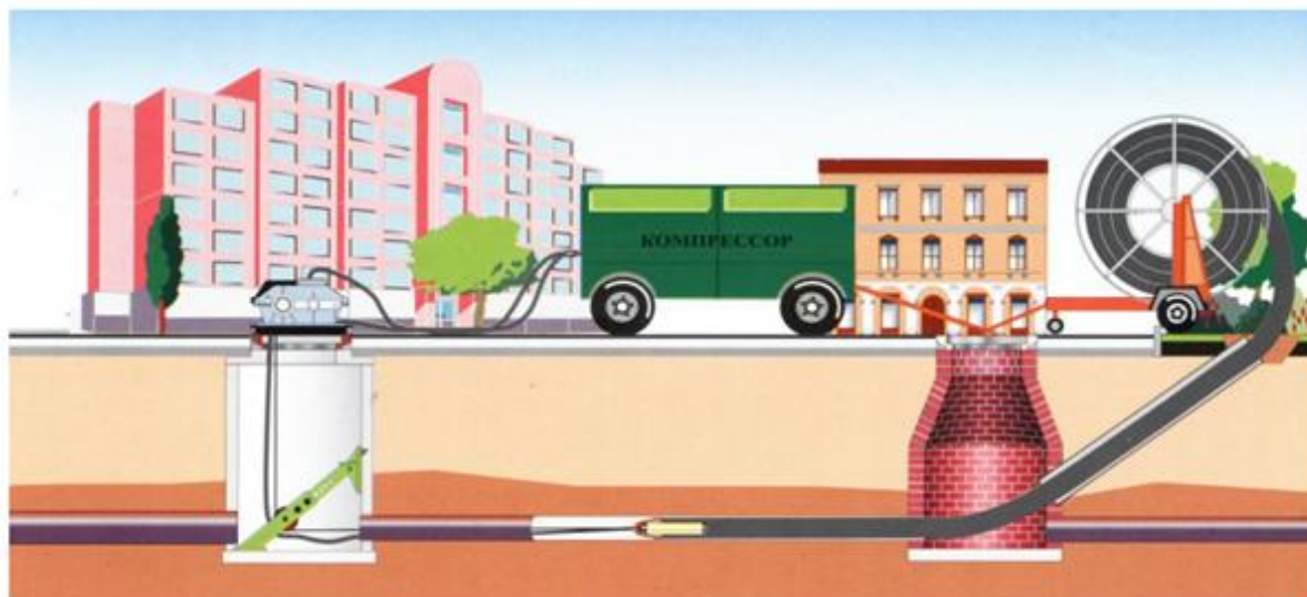
Рисунок 1.4- Восстановление водопроводной сети без разрушения
