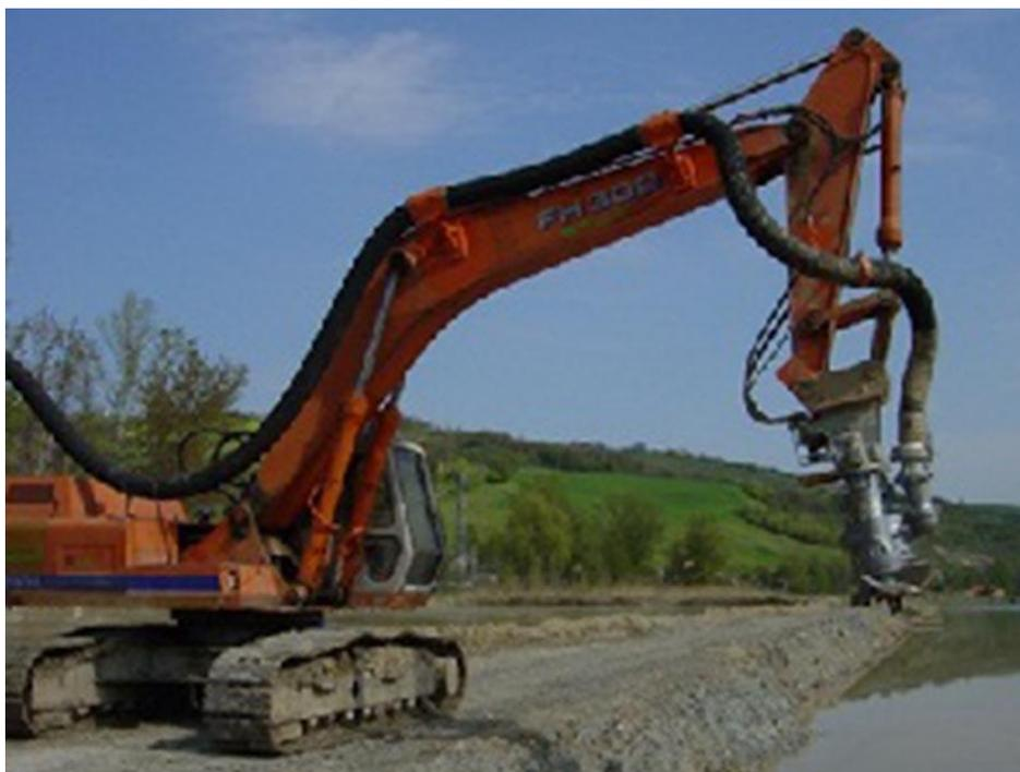
Рисунок 3.3— Работа экскаватора по очистке водоема от ила
