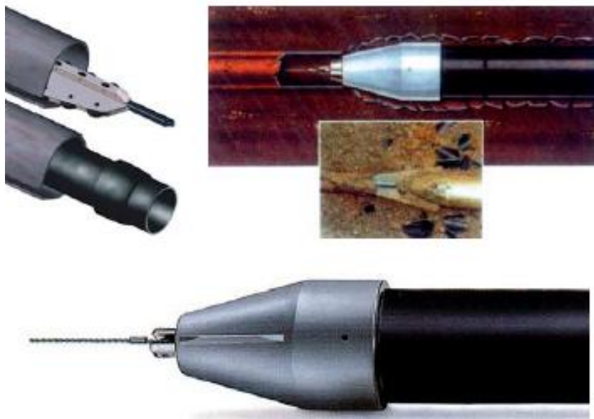
Рисунок 2.19 – Инструменты для вскрытия ремонтируемого трубопровода
