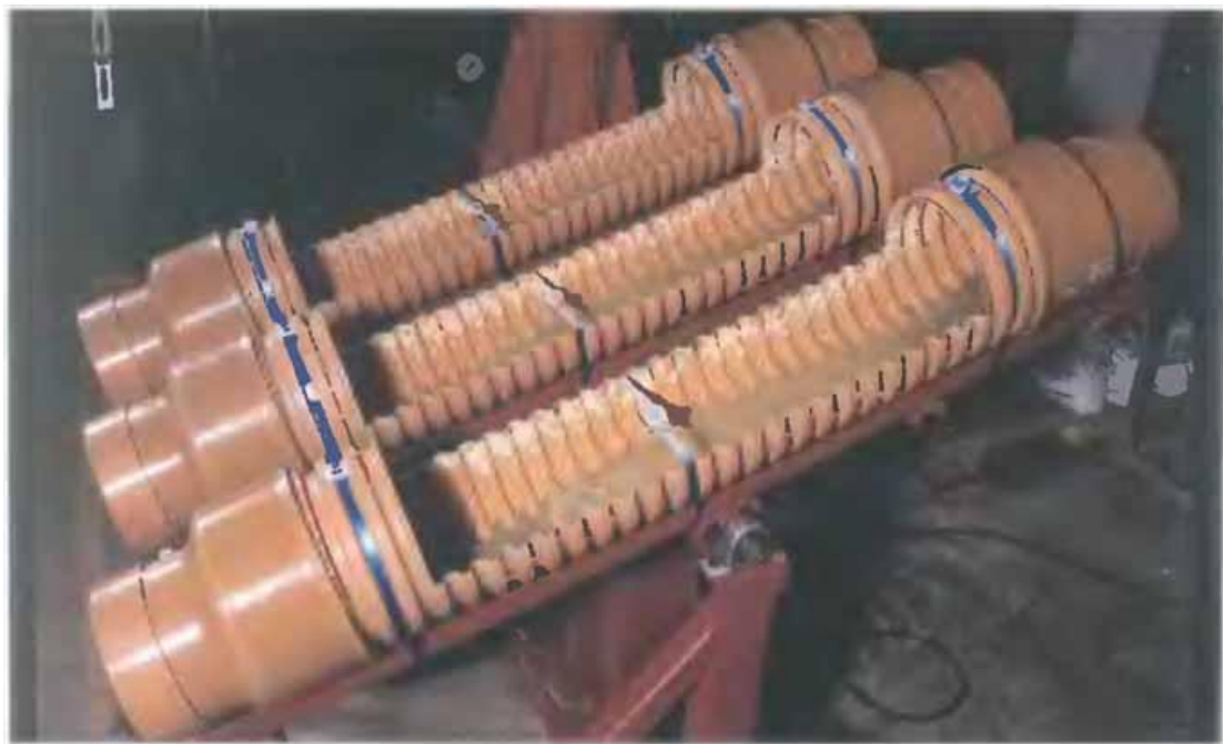
Рисунок 1.6 – Установка по истиранию трубопровода методом Дармштадта / Киршмера
