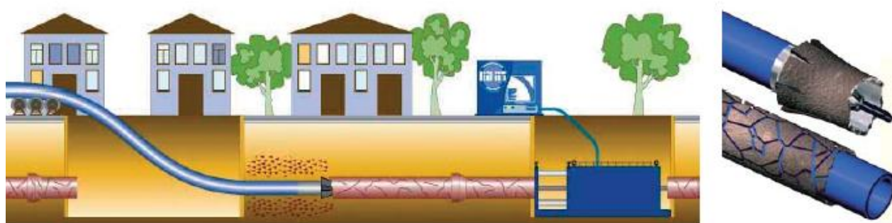
Рисунок 2.16 – Протяжка полиэтиленовой трубы с разрушением существующего трубопровода
