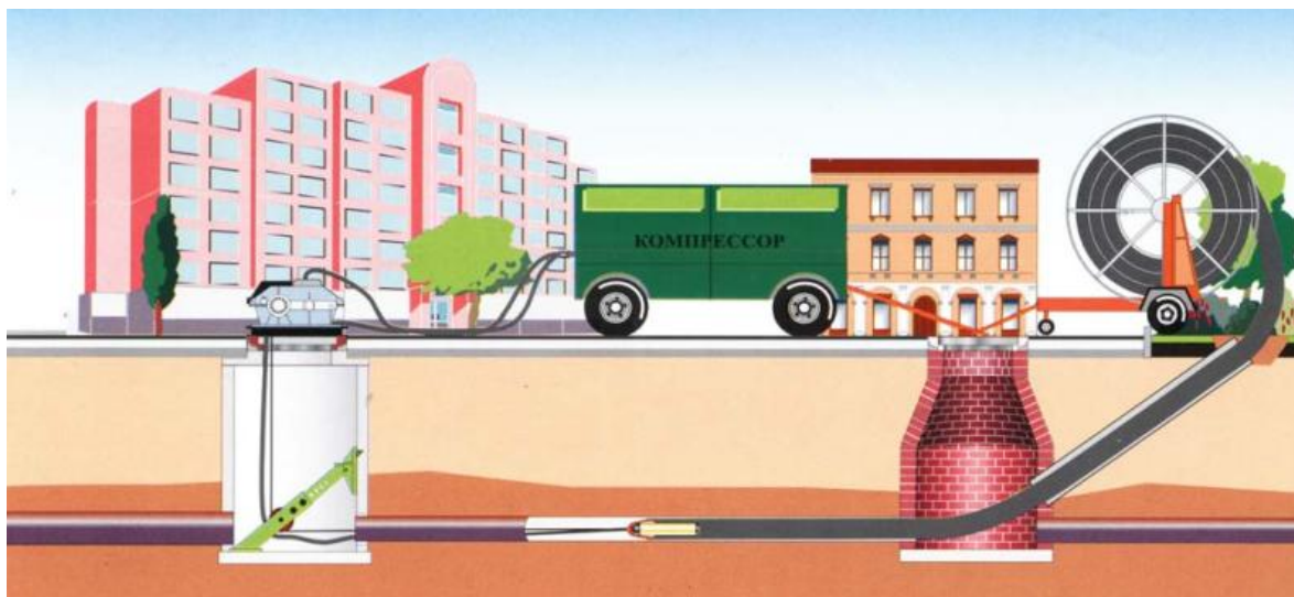
Рисунок 2.7 – Иллюстрация метода протягивания нового полимерного трубопровода в старый
