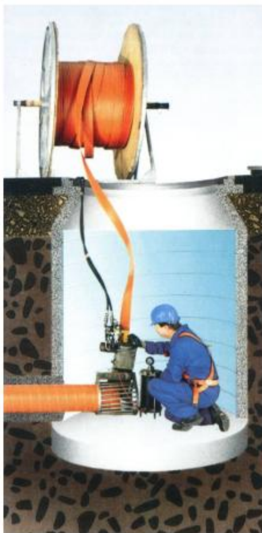
Рисунок – 2.12 Фрагмент нанесения ленточного защитного покрытия по технологии Ribloc из колодца
