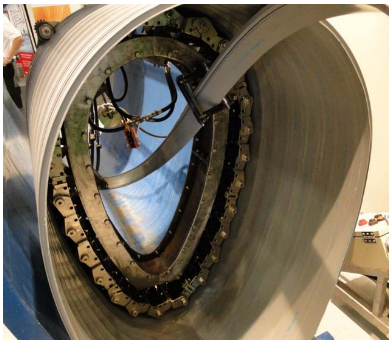
Рисунок 2.14 – Образец самодвижущейся навивочной машины, осуществляющей навивку яйцевидного профиля
