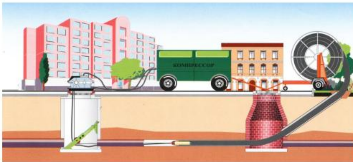
Рисунок 3.4 – Протаскивание нового трубопровода без разрушения старого
