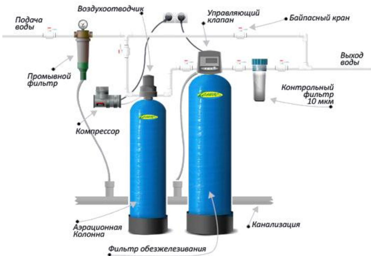
Рисунок 3.7 – Принципиальная схема установки обезжелезивания и деманганации
