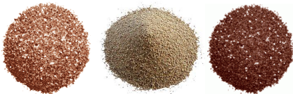
Рисунок 3.8 – Фильтрующие каталитические материалы (слева направо АС, МЖФ, МСК)
