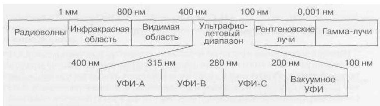
Рисунок 1.2 – Диапазоны УФИ в электромагнитном спектре
