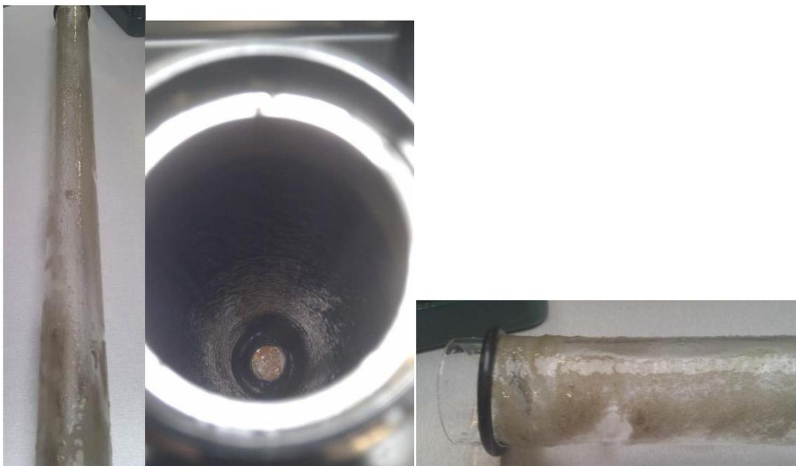
Рисунок 1.16 – Биооб­растание кварцевых защитных стёкол
