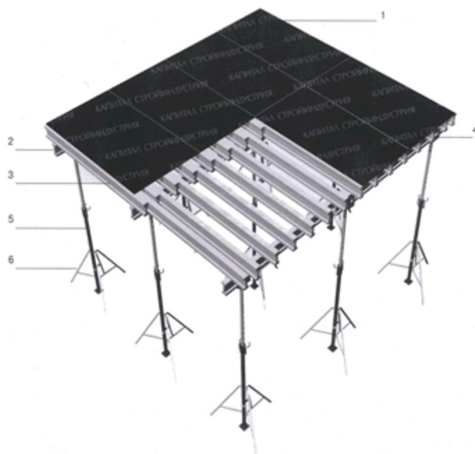
Рисунок 3.1 – Схема расстановки опалубочной системы
