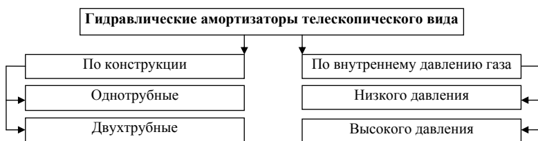
Рис. 7.13. Типы гидравлических телескопических амортизаторов
