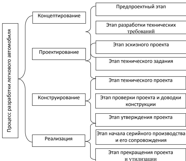
Рис. 1.2. Схема процесса разработки легкового автомобиля
