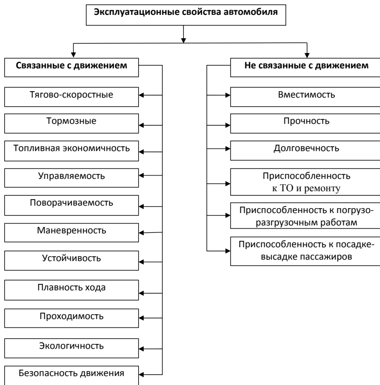
Рис. 1.1. Эксплуатационные свойства автомобиля
