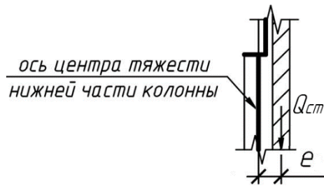
Рисунок 2.3 – Схема для определения нагрузки от сэндвич-панелей
