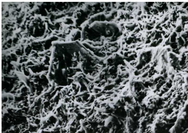
Рис. 3. Контактная поверхность заполнителя с короткими отдельными кристаллами этtringита (ув. 2000 \times ). Разрушенный бетон жилого дома
