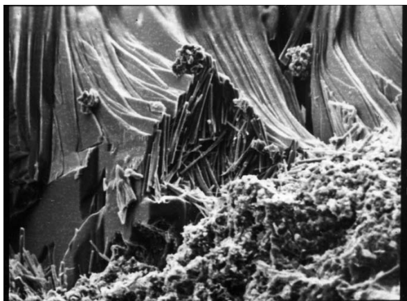
Рис. 8. Образование этtringита на поверхности зерна гипса. Возраст образца – 1,5 года (ув. 2000 х )
