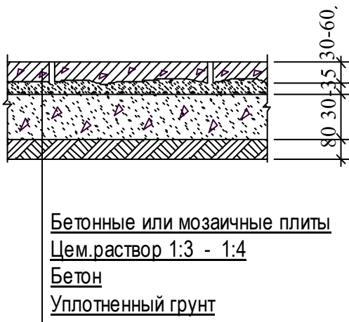
Рис.1.1 Схема устройства бетонных полов
