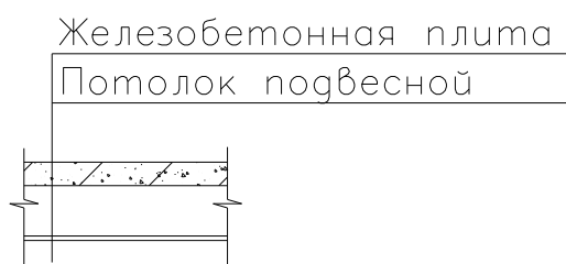
Рисунок 2.3 – Схема перекрытия техэтажа автовокзала
