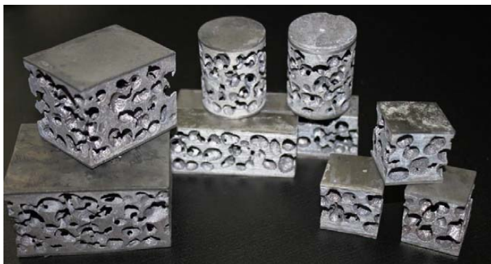
Рис. 22. Внешний вид слоистого пенокомпозита алюминий – титан
