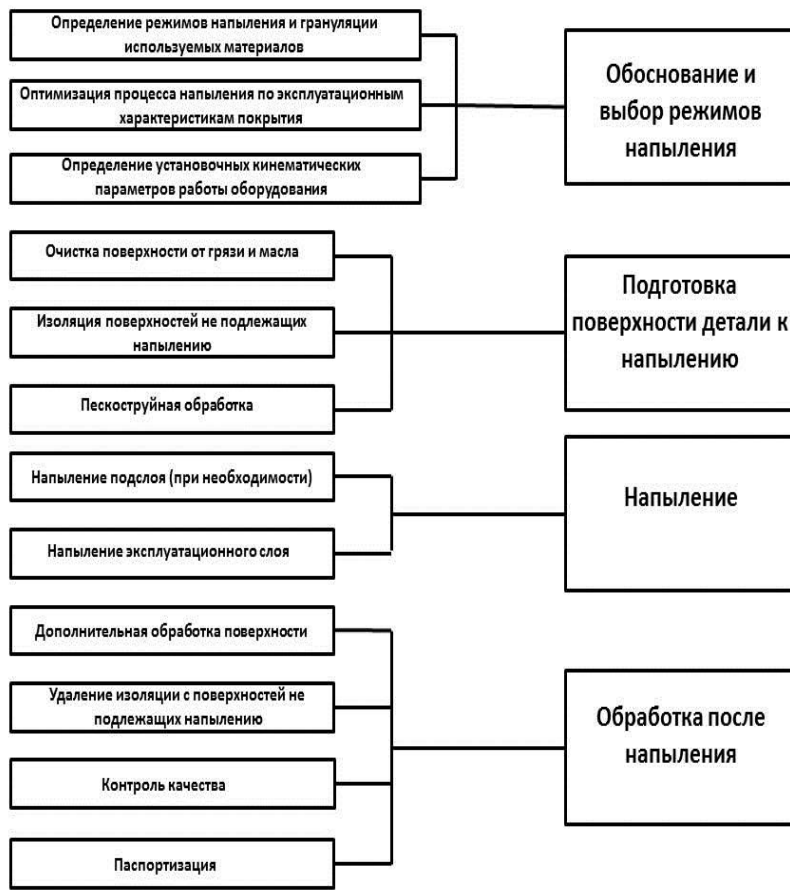
Рис. 24. Схема технологического процесса плазменного напыления при получении металлических композиционных материалов
