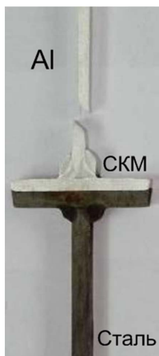
Рис. 29. Тавровое (крестообразное) сварное соединение стальной и алюминиевой деталей, выполненное с применением переходного элемента из СКМ алюминий – сталь после испытания на растяжение
