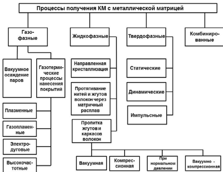
Рис. 7. Общая классификация процессов получения и обработки композитов с металлической матрицей [15]
