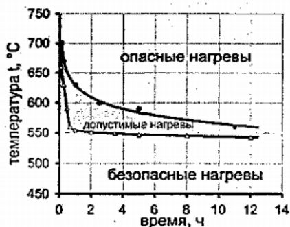
Рис. 33. Температурно-временная зависимость образования интерметаллидов в титано-алюминиевых СКМ: 1 – зона безопасных нагревов (интерметаллидов нет); 2 – зона допустимых нагревов (толщина интерметаллидов < 2 мкм); 3 – зона недопустимых нагревов (толщина интерметаллидов > 2 мкм) [62]
