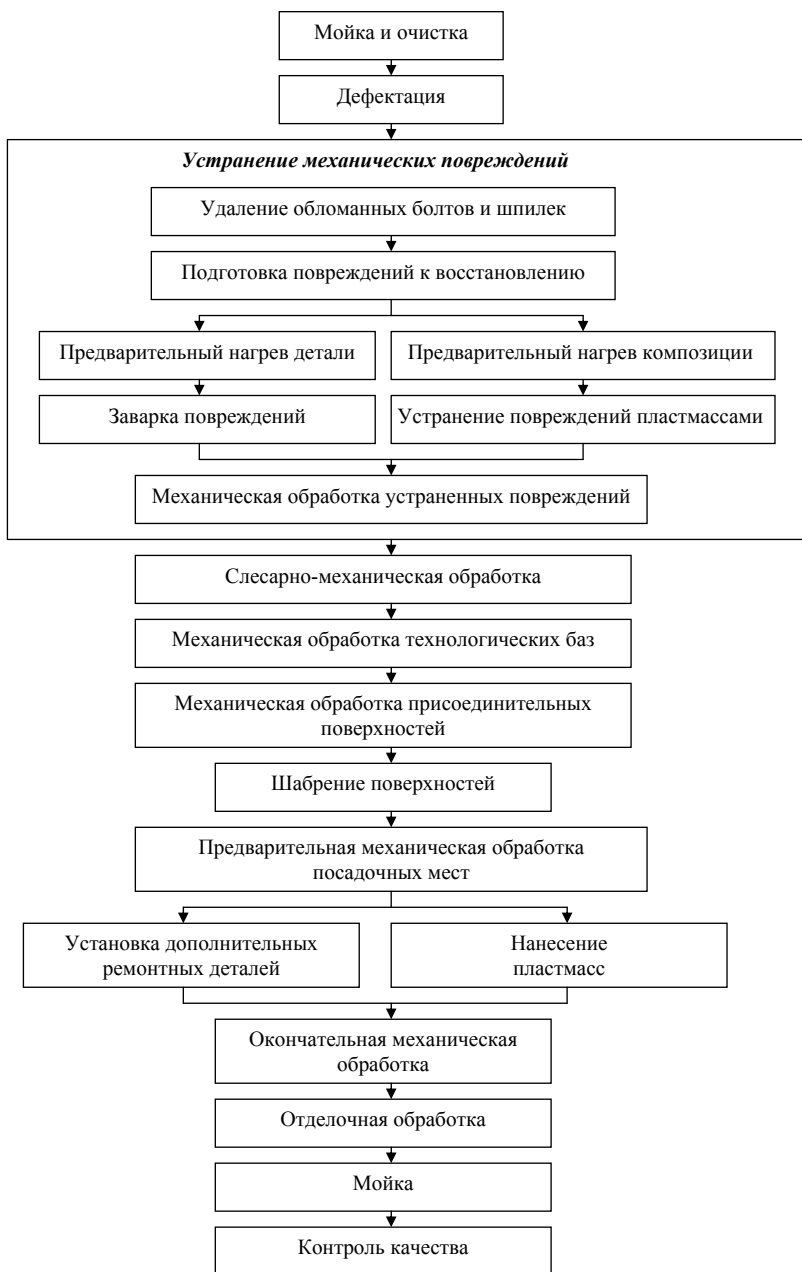
Рис. 6.2. Структура технологического процесса восстановления корпусных деталей
