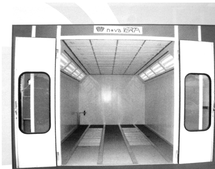
Рис. 9.15. Вид окрасочно-сушильной камеры
