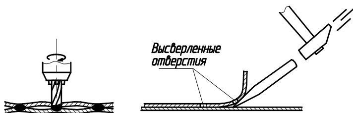
Рис. 8.23. Процесс снятия приваренной панели
