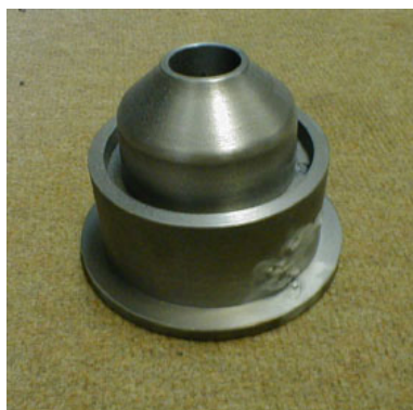
Рис. 6.3. Вид устраненного повреждения чугунной детали методом газодинамического напыления
