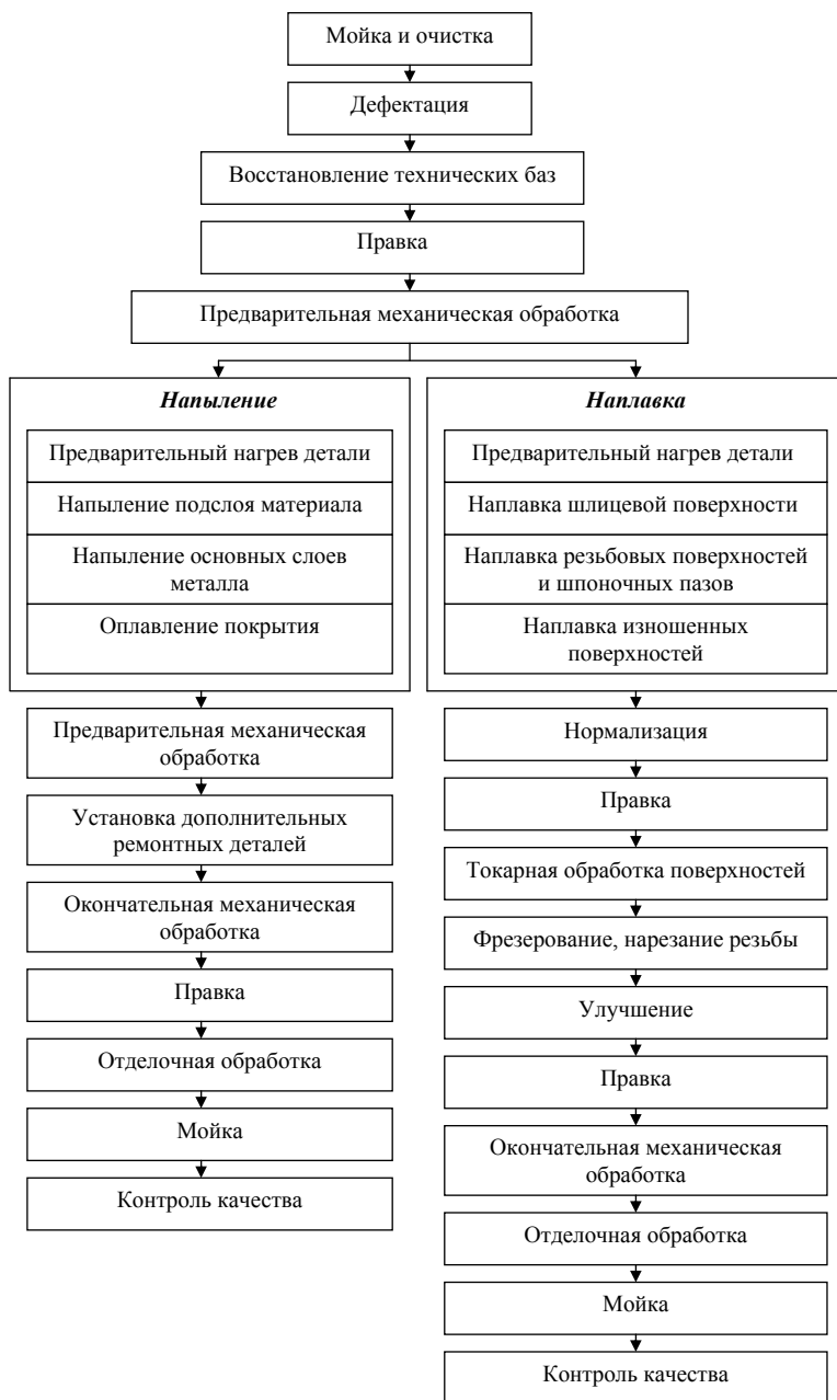
Рис. 6.7. Структура технологического процесса восстановления деталей, относящихся к классу круглых стержней
