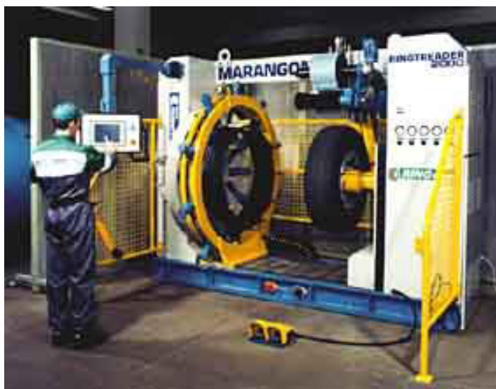
Рис. 10.4. Восстановление автомобильных шин по технологии «Marangoni» путем приклеивания готовых протекторов кольцеобразной формы
