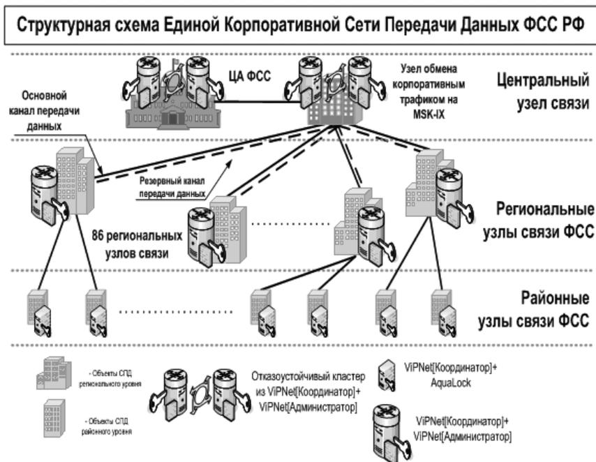
Рис. 13. Структурная схема ЕКСПД ФСС РФ
