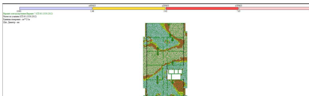
Рисунок 10 – Нижнее армирование плиты перекрытия вдоль оси Y на отм. +3,300 в осях 10-18/Ж-Л
