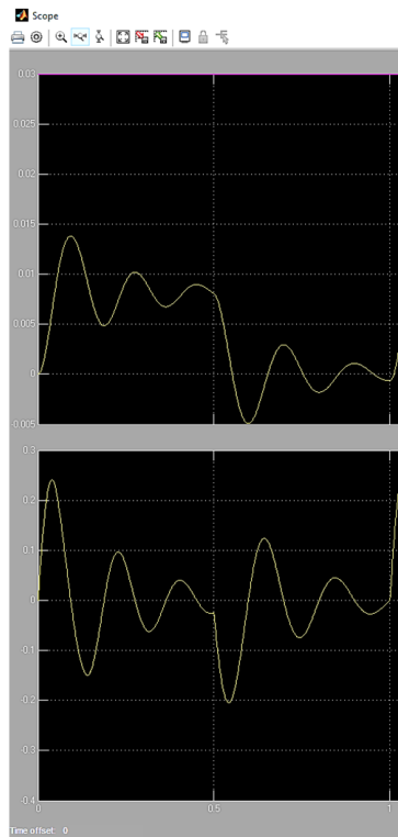
Рис. 4.3. Диаграммы перемещения и скорости для прямоугольного импульса тока с амплитудой 9600 А, периодом T = 1 с, заполнением импульса 50 %
