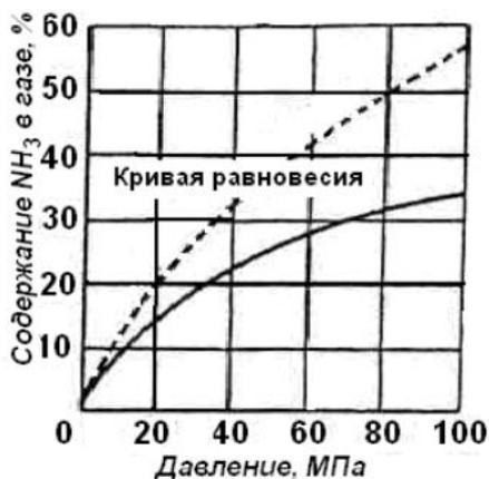
Рисунок 1 – Зависимость выхода аммиака от давления (объёмная скорость 30 000 ч<sup>-1</sup>; t = 500°C; катализатор железный)
