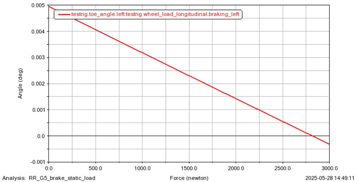
Рисунок 41 – Изменение схождения на задней оси при тормозном усилии
