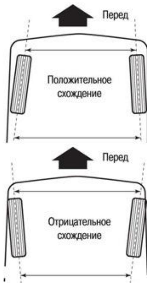
Рисунок 16 – Настройка углов схождения автомобиля
