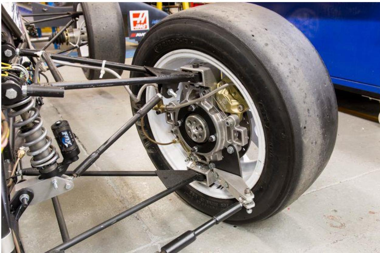
Рисунок 1 – Конструкция передней подвески с системой pull-rod
