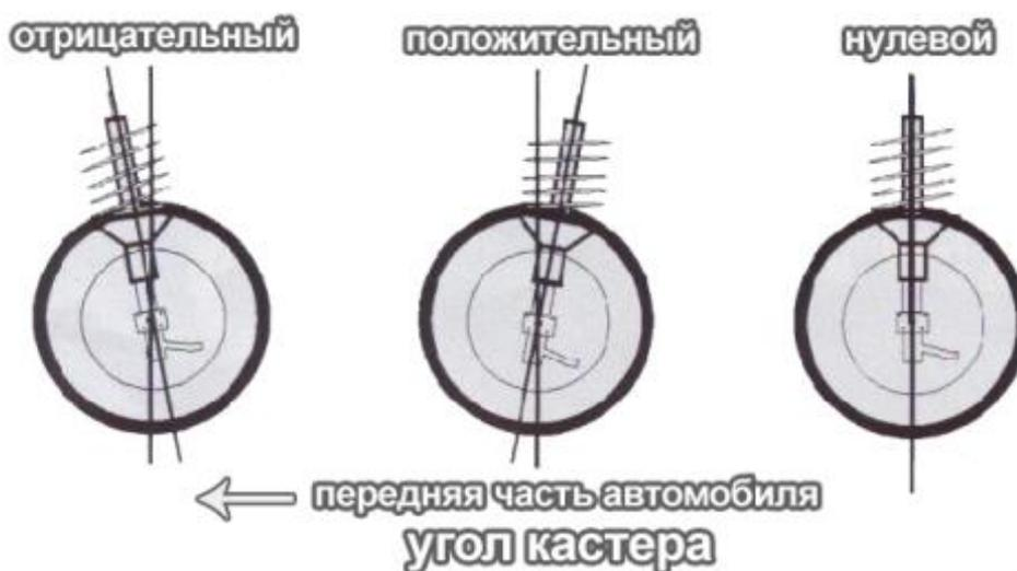
Рисунок 13 – Положительный, отрицательный и вертикальный углы кастера
