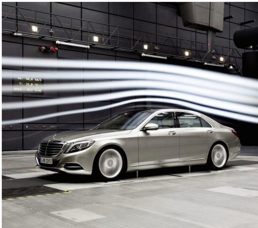
Рисунок 12 – Испытания автомобиля в аэродинамической трубе
