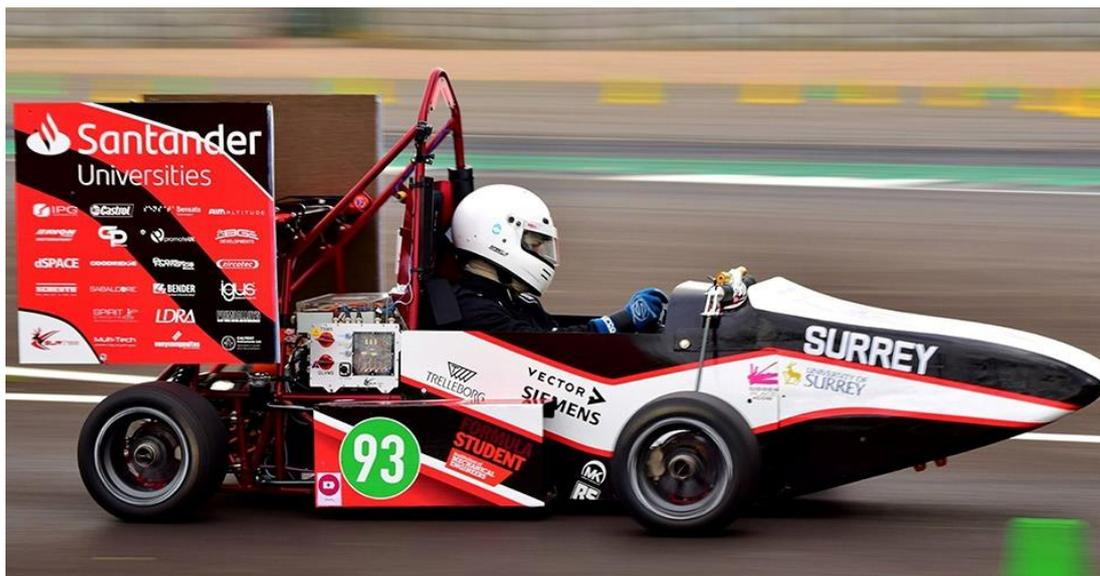
Рисунок 7 – Конструкция гоночного болида класса «Формула Студент» с использованием аэродинамических боковых структур и только заднего антикрыла
