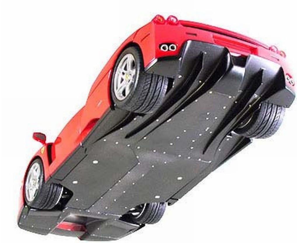
Рисунок 24 – Пример аэродинамического дна гоночного автомобиля
