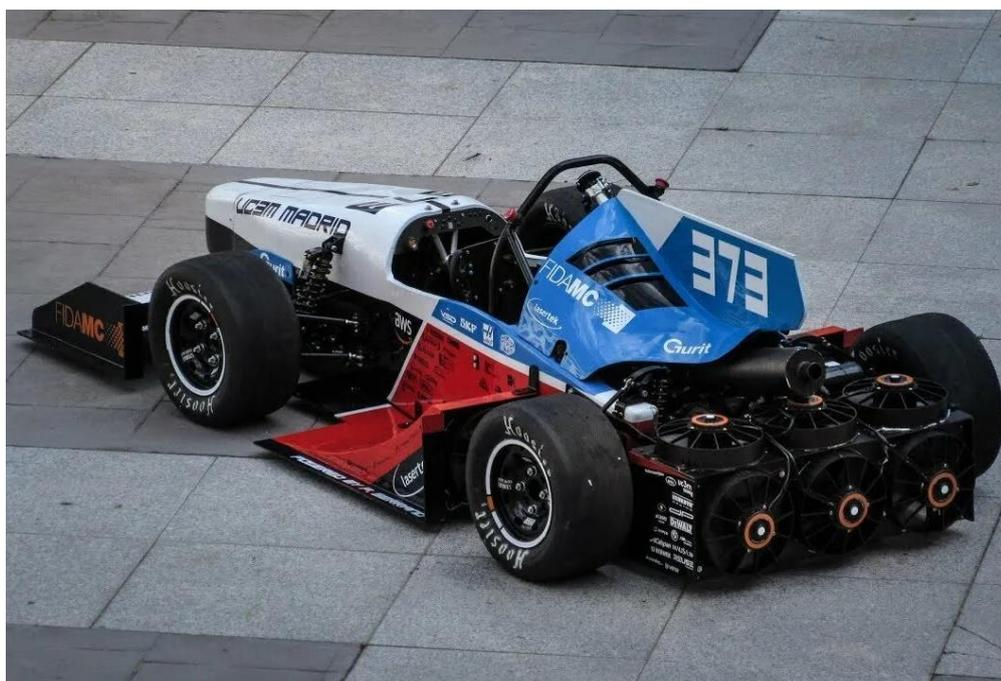
Рисунок 6 – Конструкция гоночного болида класса «Формула Студент» с использованием аэродинамических боковых структур и только переднего антикрыла
