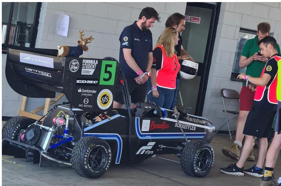
Рисунок 8 – Конструкция гоночного болида класса «Формула Студент» с использованием аэродна и только заднего антикрыла
