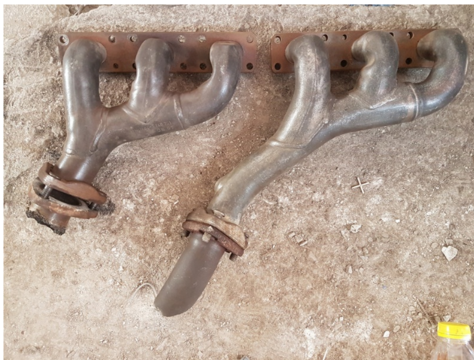
Рисунок 22 – Выпускной коллектор для ДВС с 2 головками блока цилиндров
