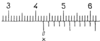
Рис. 4–5.6. Отсчет по нониусу целых миллиметров. Количество целых миллиметров равно 42
