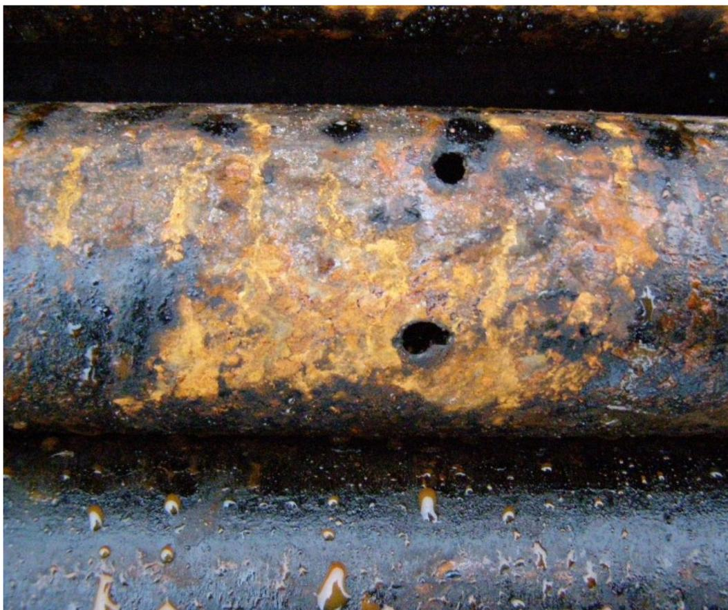
Рисунок 4 – Сквозные разрушения трубопровода
