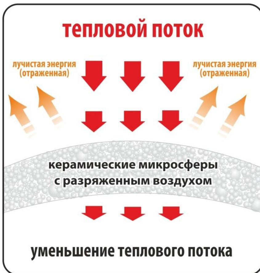
Рисунок 16 – Схема прохождения теплового потока через слой теплоизоляции «Броня»
