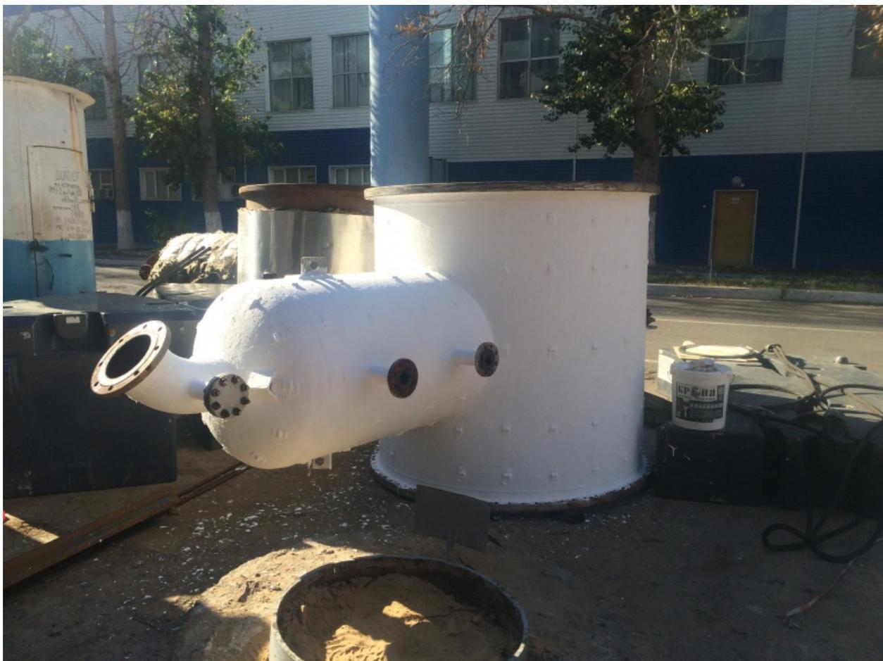
Рисунок 18 – Изоляция оборудования покрытием «Броня»
