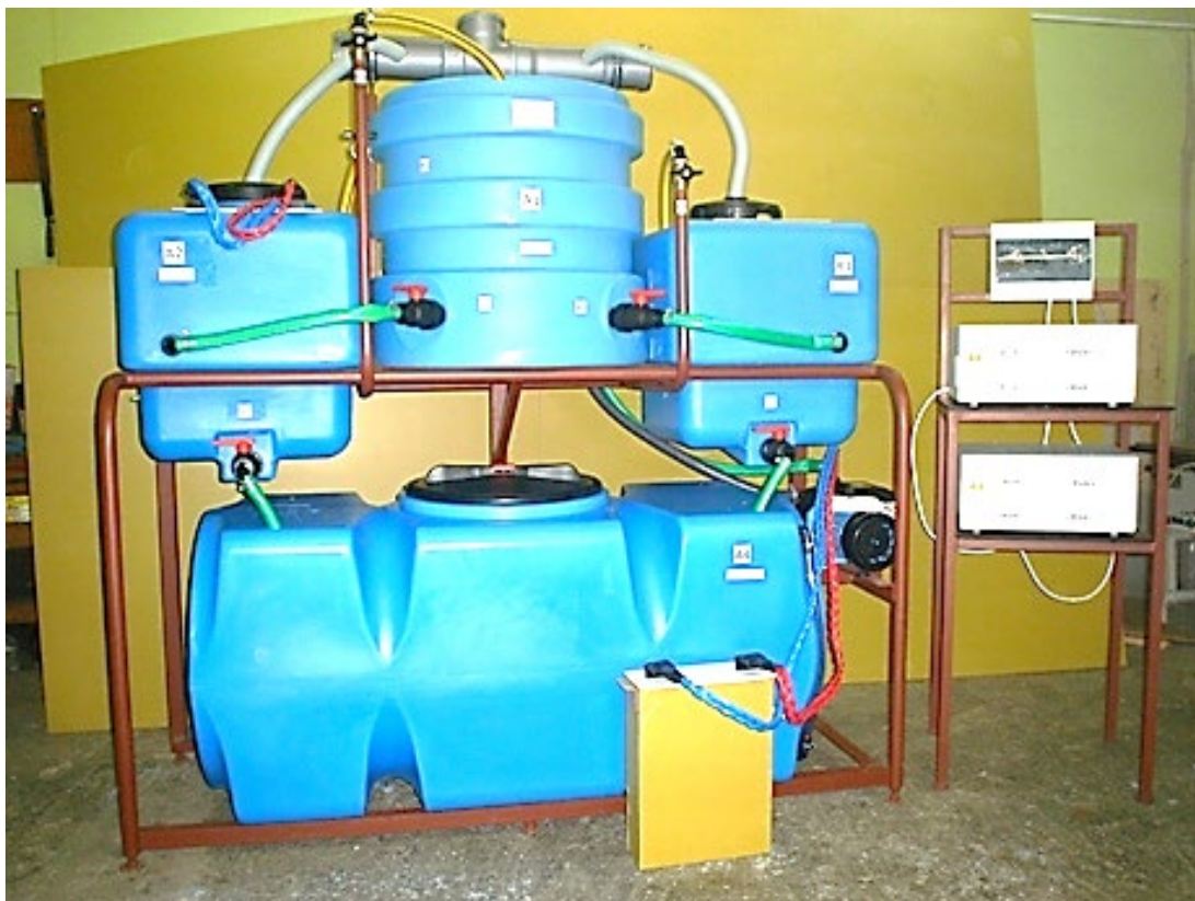
Рисунок 10 – Электролизная установка заводского изготовления «САНЕР 5-400-3»
