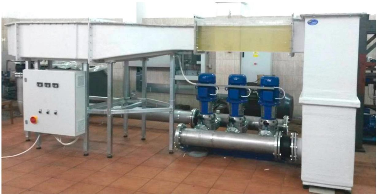
Рисунок 6 – Гидравлический стенд с замкнутым контуром
