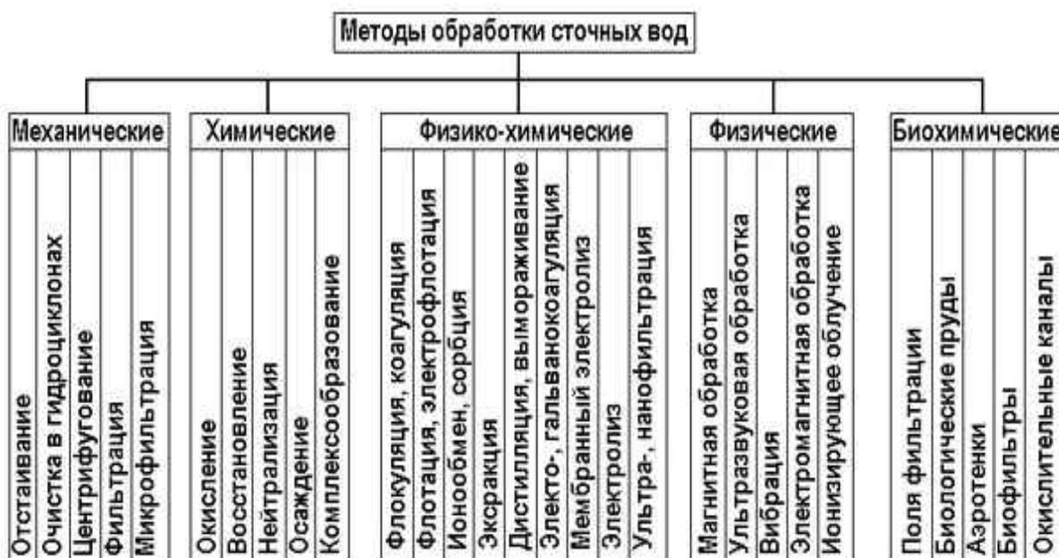
Рисунок 3 – Физико-химические методы очистки сточных вод
