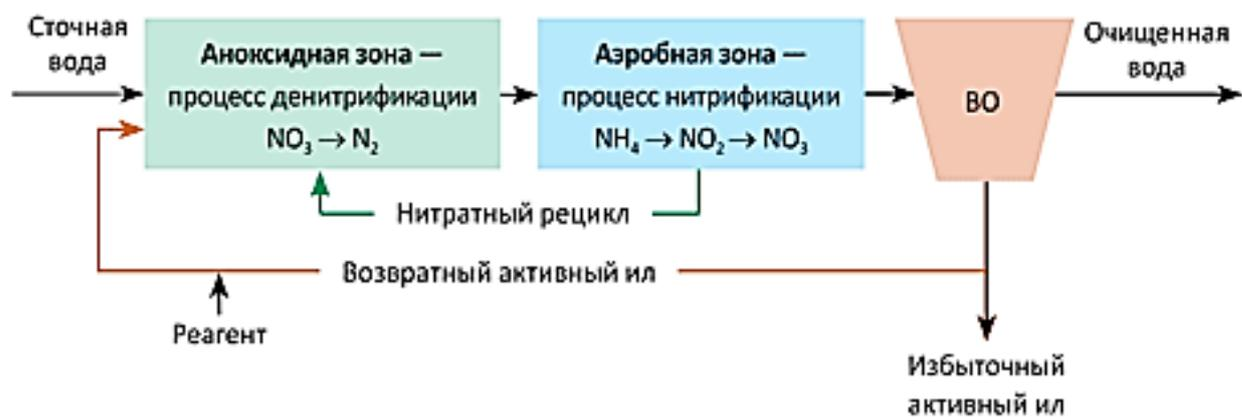
Рисунок 4 – Схема очистки аммоний содержащих стоков
