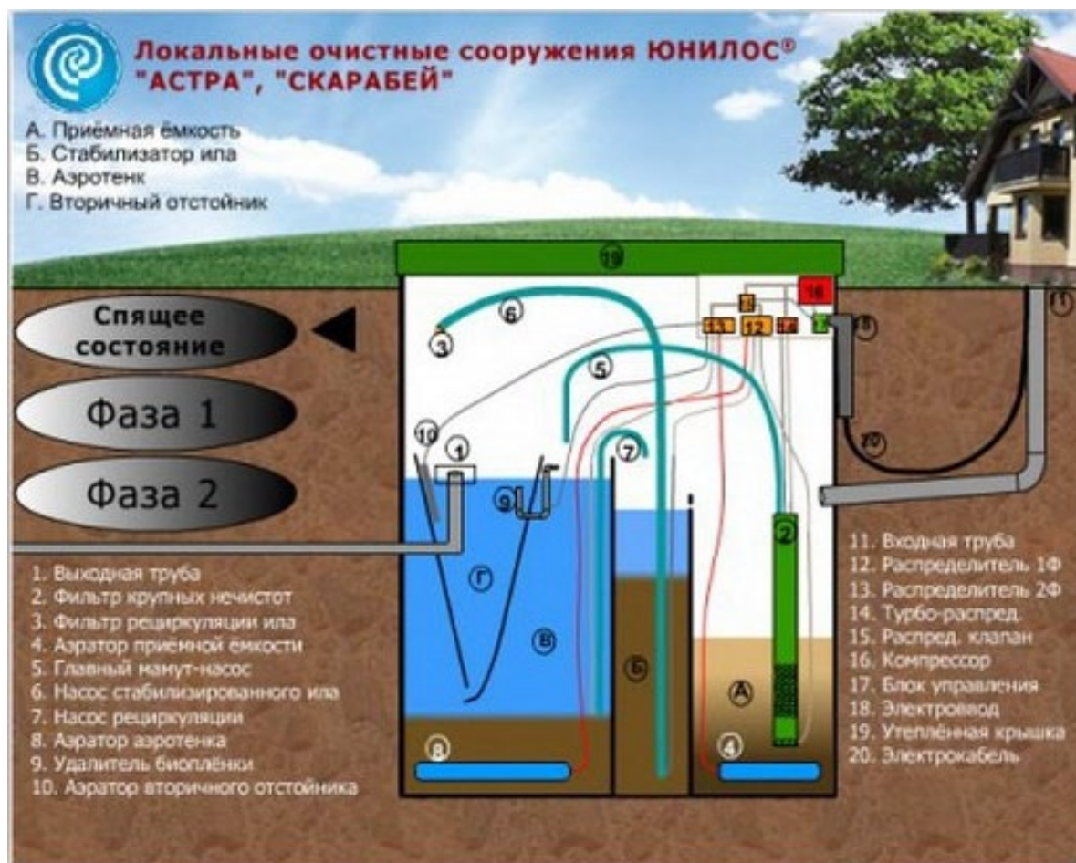
Рисунок 9 – Пример локальных очистных сооружений
