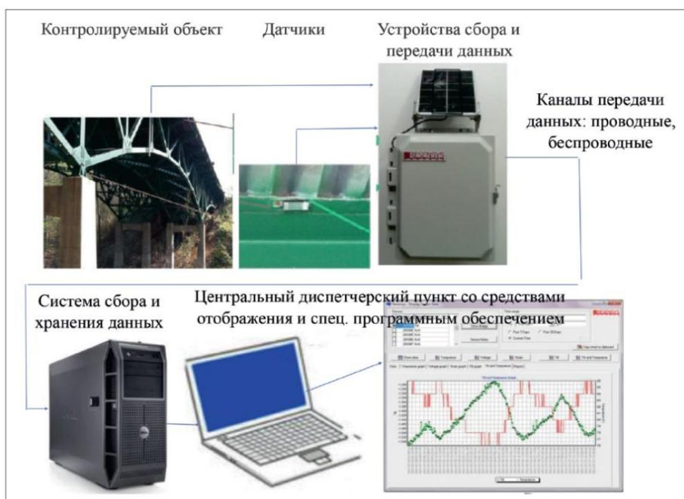
Рисунок 5 – Общая структурная схема системы мониторинга
