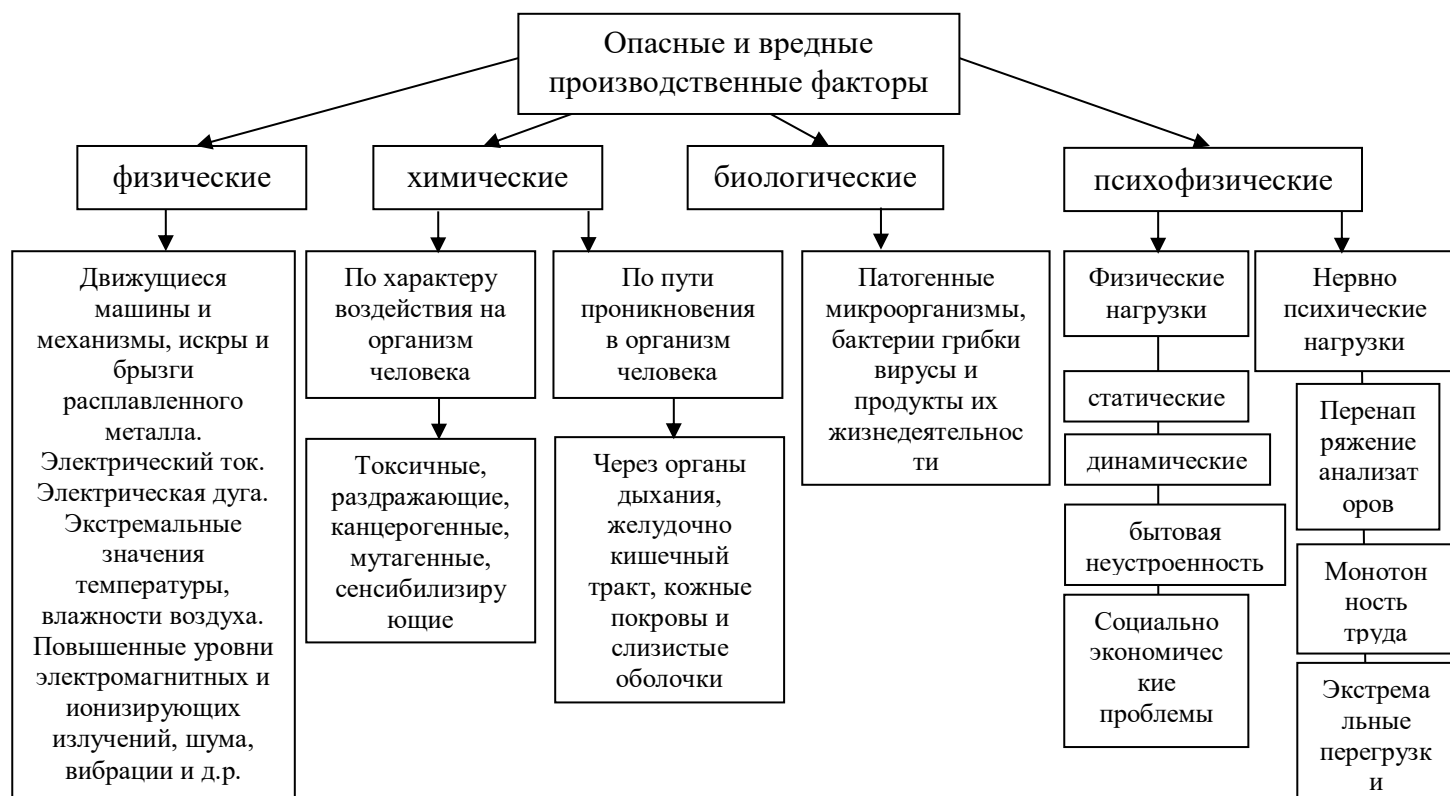
Рисунок 1 – Классификация вредных и (или) опасных производственных факторов [4]
