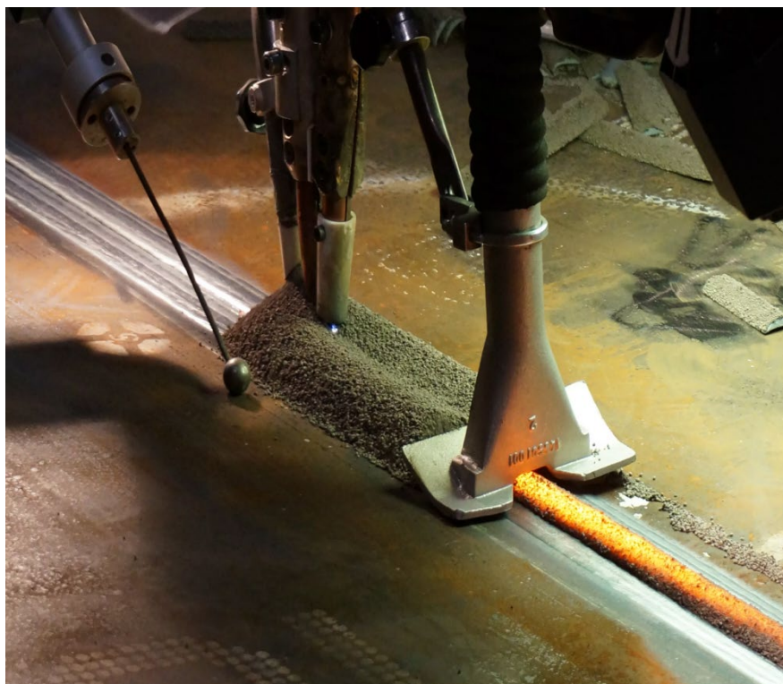
Рисунок 10 – Сварка под флюсом
