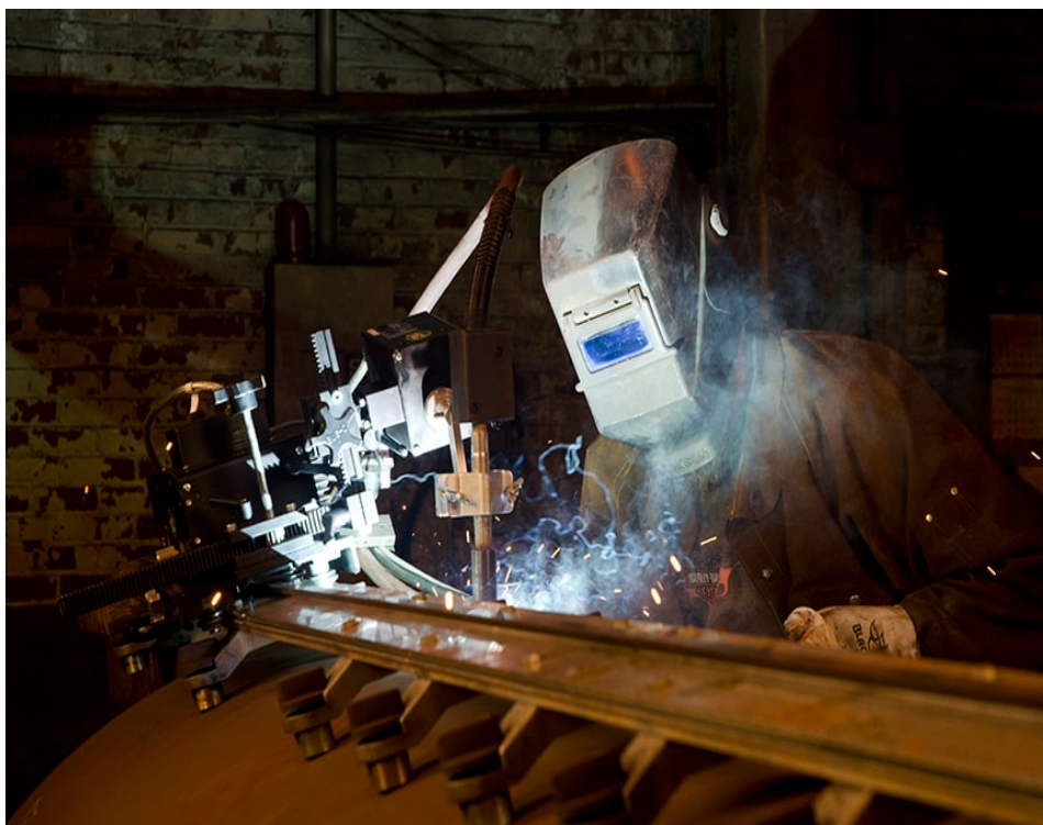
Рисунок 8 – Механизированная сварка плавящимся электродом
