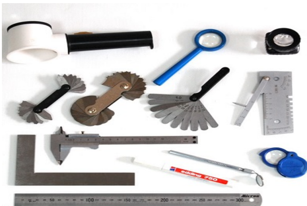
Рисунок 14 – Инструменты для визуального и измерительного контроля
