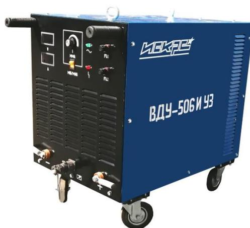
Рисунок 9 – Сварочный выпрямитель ВДУ-506
