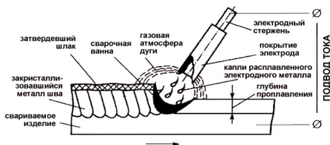
Рисунок 10 – Схема ручной дуговой сварки
