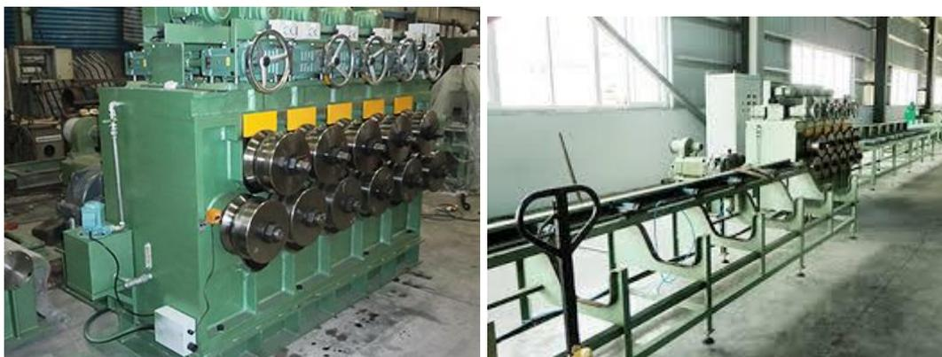
Рисунок 4 – Малоразмерная сортоправильная машина JZJ20-40
