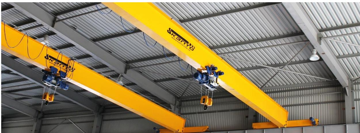
Рисунок 7 – Крюковый однобалочный кран
