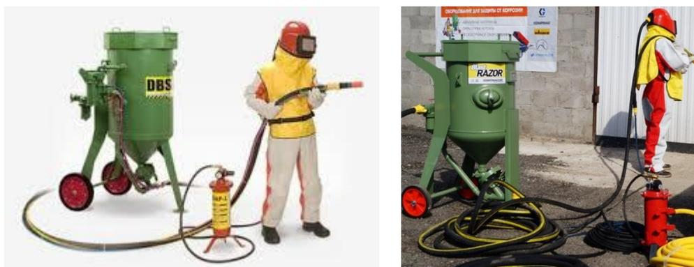
Рисунок 3 – Мобильная пескоструйная установка DBS-100
