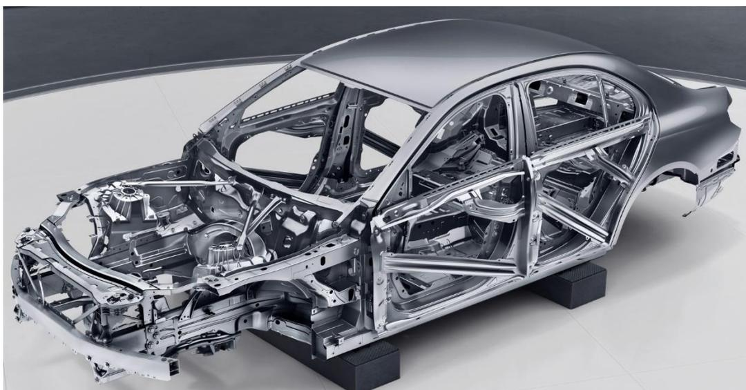
Рисунок 2 – Кузов автомобиля, выполненный на 90 % из алюминиевых сплавов
