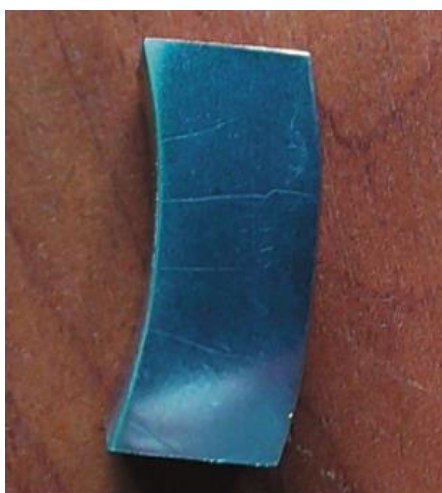
Рисунок 6 – Образец из дефектного участка реакционной трубы
