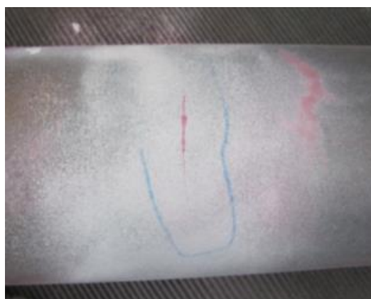
Рисунок 5 – Обнаруживающиеся трещины на внутренней поверхности оголовка реакционной трубы
