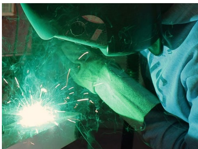
Рисунок 5 – Ручная дуговая сварка и наплавка штампов
