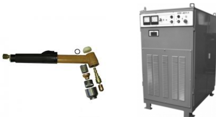
Рисунок 20 – Оборудование для воздушно-плазменной резки при разделке дефекта на штамповой оснастке: резак ПРВ-202 и источник питания УПР-201
