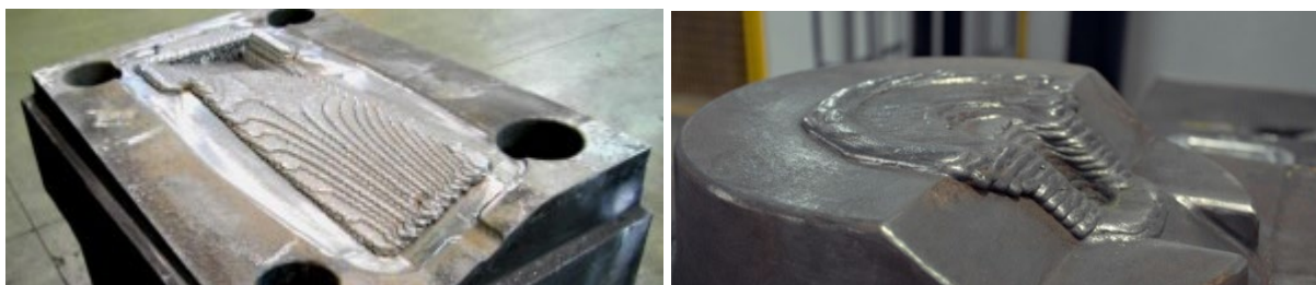
Рисунок 21 – Поверхность штампа после восстановительной наплавки
