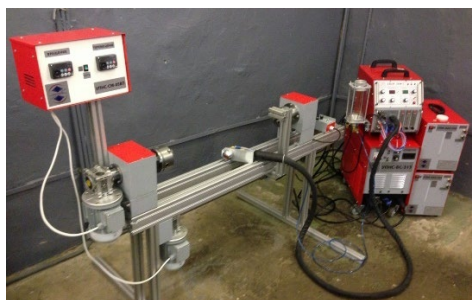
Рисунок 10 – Установка для плазменной наплавки экспериментальных образцов
