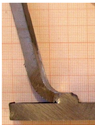
Рисунок 9 – Натуральный образец на статический изгиб
