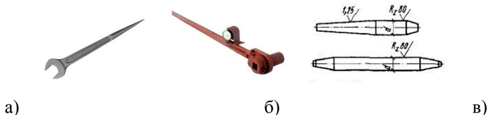
а – монтажный коликовый ключ; б – динамометрический ключ; в – оправки
