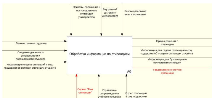
Рисунок 16 – Контекстная диаграмма процесса обработки информации по стипендии «ТО ВЕ»
