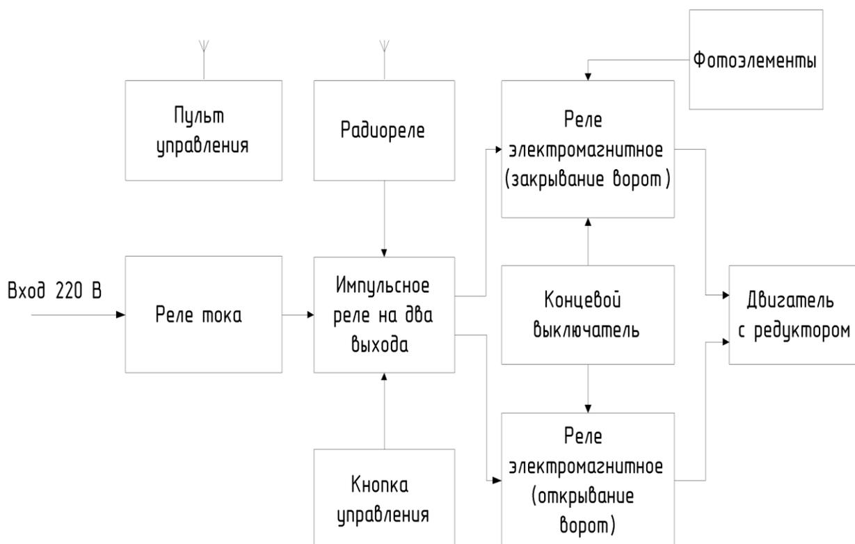
Рисунок 2 – Структурная схема контроллера
