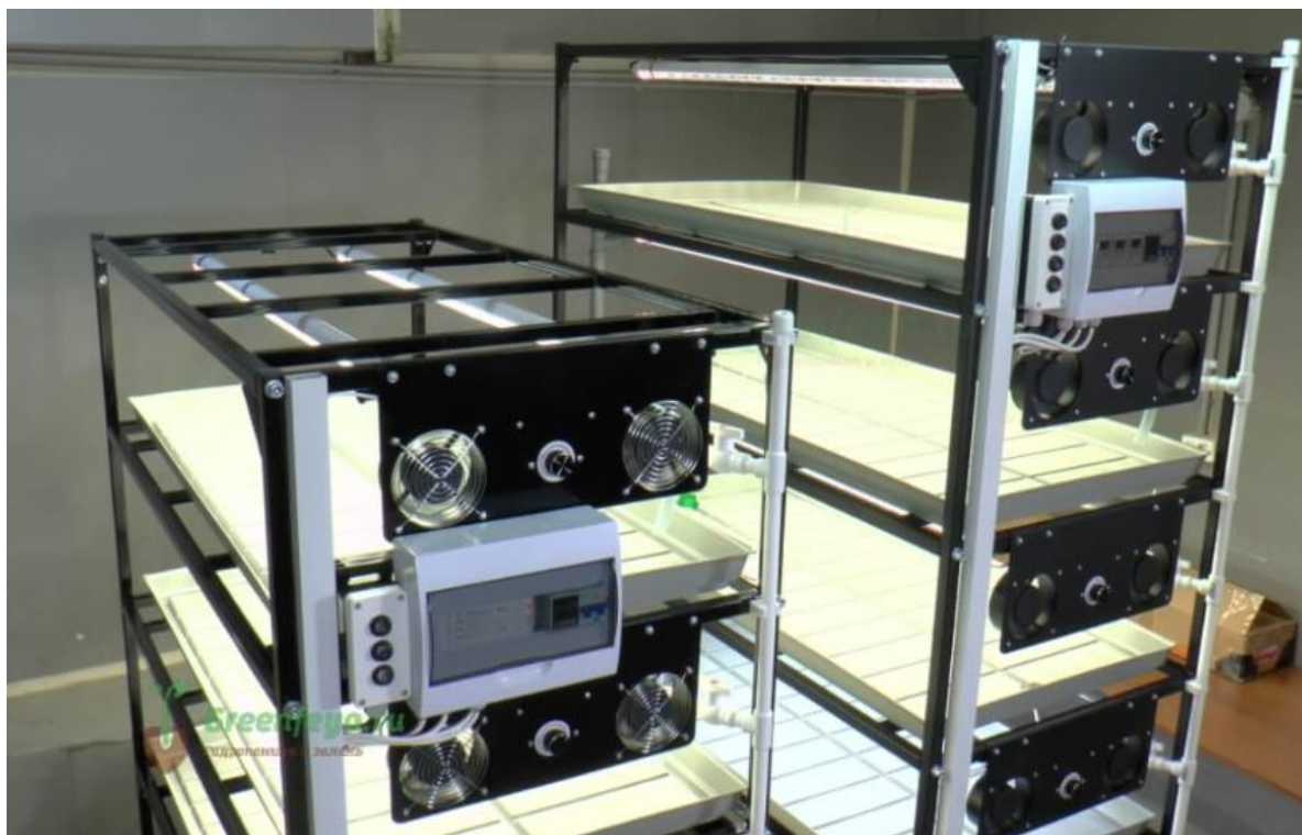
Рисунок 7 – Автоматизированный стеллаж для гидропоники от компании Greenfeya
