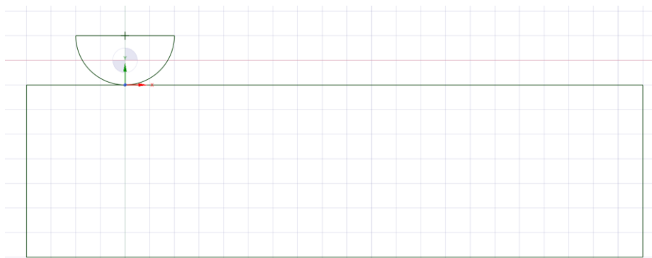
Рисунок 6 - Эскиз обработки вала поверхностным пластическим деформированием
