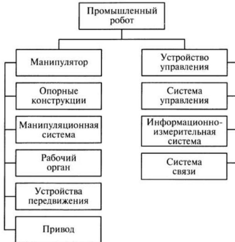
Рисунок 2- Структурная схема промышленного робота
