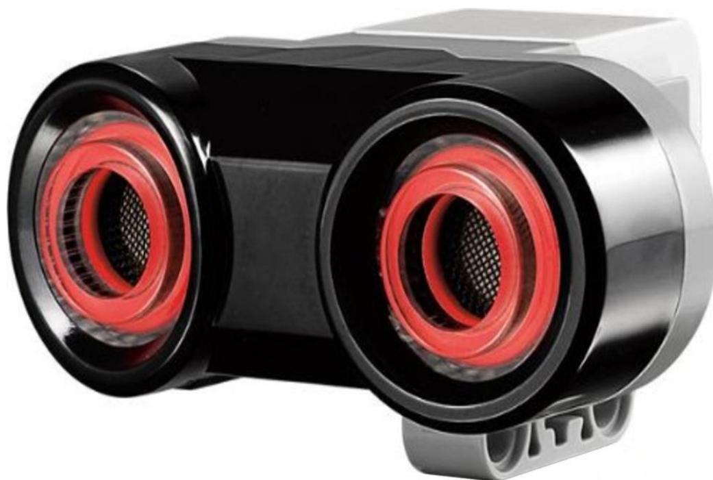
Рисунок 10– Ультразвуковой датчик
