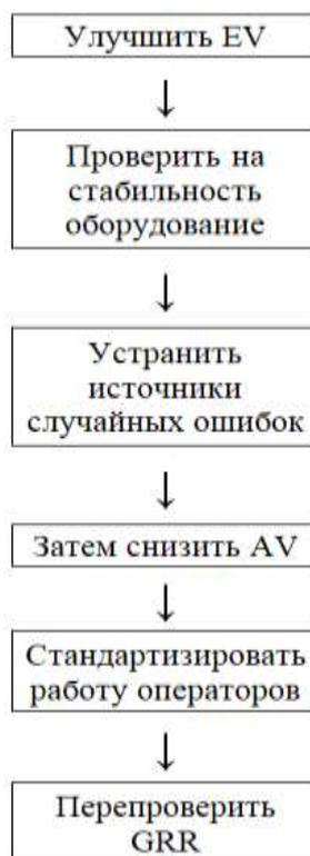
Рисунок 32 – План корректирующих действий
