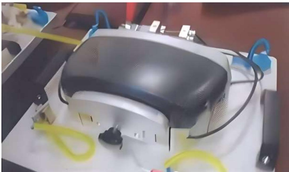
Рисунок 5 – Установленный кожух руля в калибре
