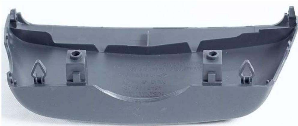
Рисунок 2 – Верхний кожух рулевого вала (вид снизу)
