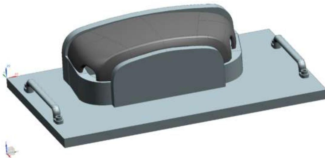
Рисунок 9 – Деталь в калибре: изометрический вид
