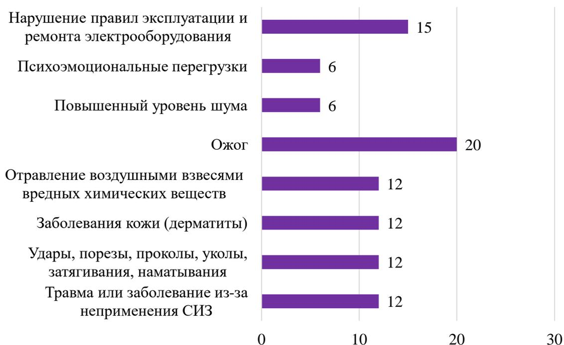
Рисунок 6 – Диаграмма по уровню рисков оператора машин и установок по производству изделий из пластмасс, R (количественная оценка рисков)
