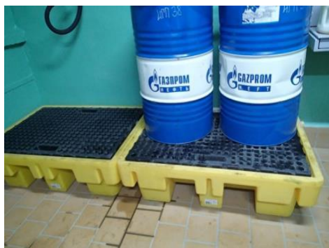
Рисунок 8 – Пример хранения ЛВЖ, ГЖ и ГСМ в бочках на негорючем прорезиненном поддоне
