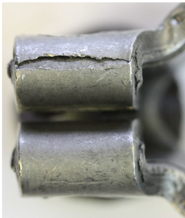
Рисунок 8 – Расслоение на участке детали с перегибом металла на 180°
