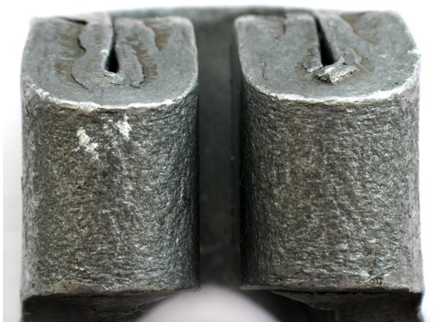
Рисунок 10 – Наволакивание металла по линии вырубki
