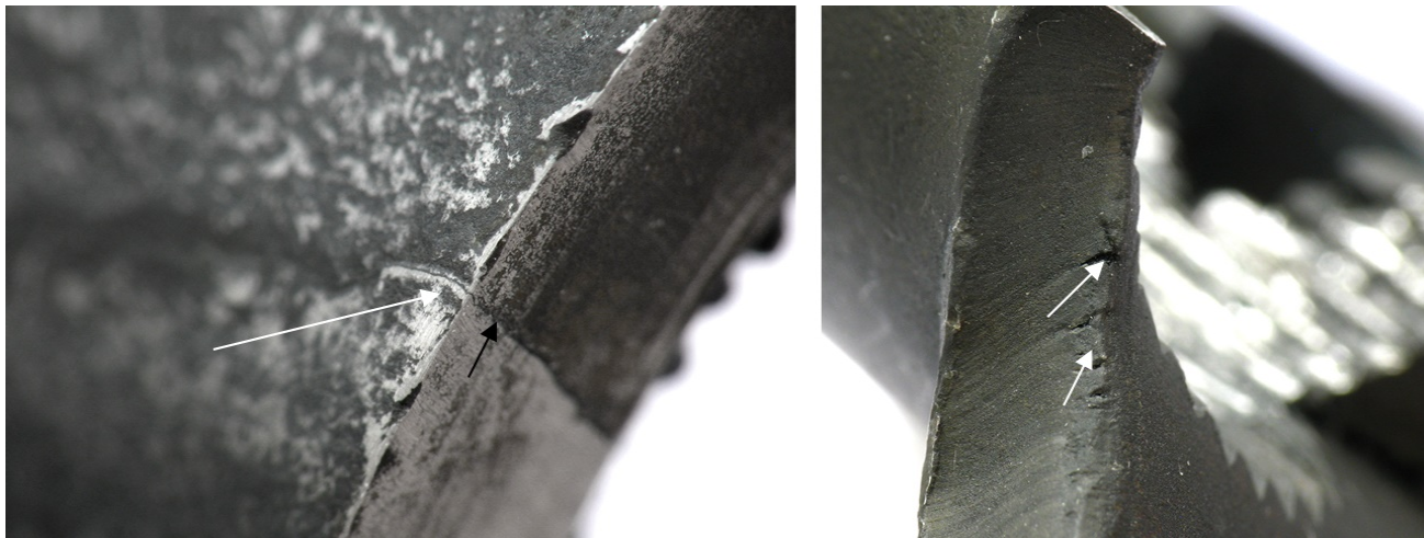
Рисунок 7 – Трещины по месту перегиба (деталь после испытаний)
