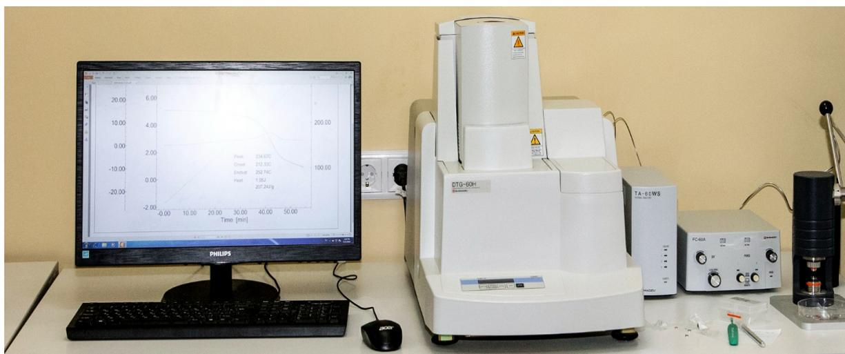
Рисунок 7 – Синхронный термоанализатор Shimadzu DTG – 60H
