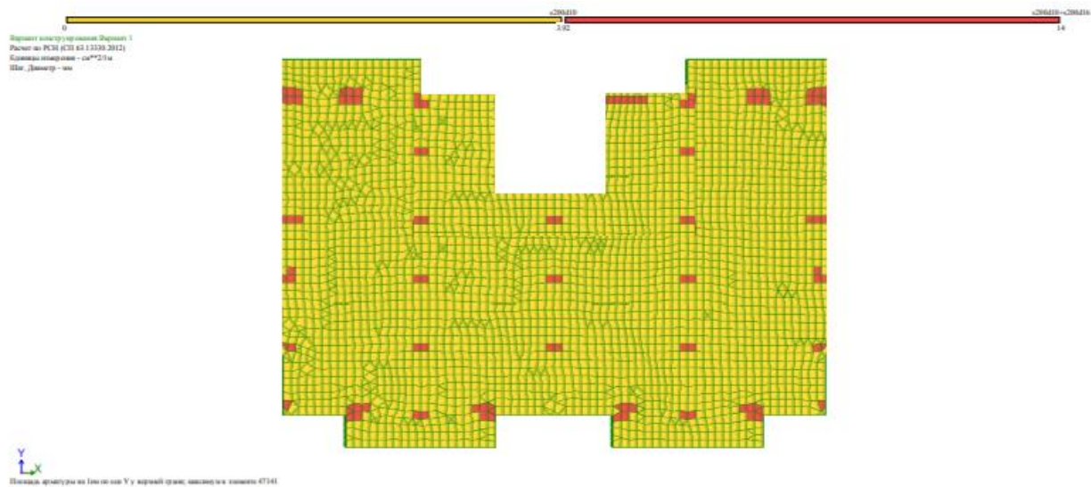
Рисунок 9 – Верхнее армирование ОУ
