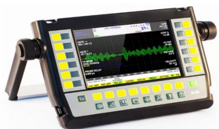
Рисунок 15 – Контроль сварных соединений
