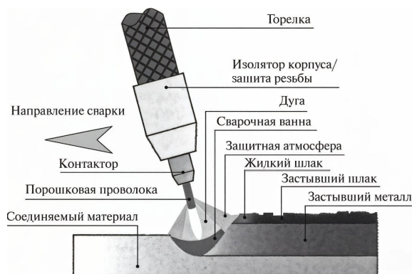
Рисунок 5 – Схема механизированной сварки порошковой проволокой в среде защитных газов
